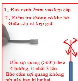
2. Mở kẹp giữ cáp và cố định Cáp thật chắc chắn trong kẹp giữ
