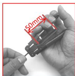
1. Dùng dao tuốt vỏ cáp Lấy đoạn sợi theo yêu cầu
