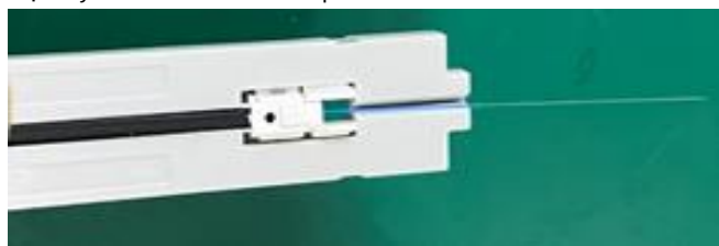
Đặt dây thuê bao vào thước cắt sợi quang
