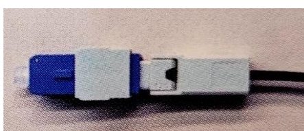
Đóng nắp khóa đuôi cáp và tháo bỏ khóa 250/125µm, để hoàn thành
